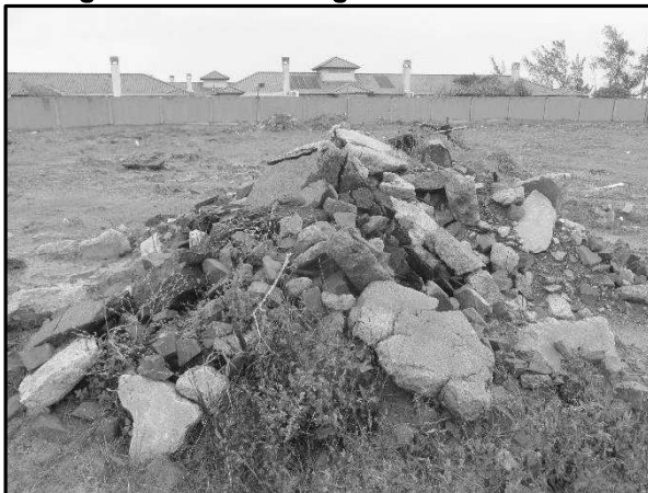
Figura 14. RCC e fragmentos asfálticos.
