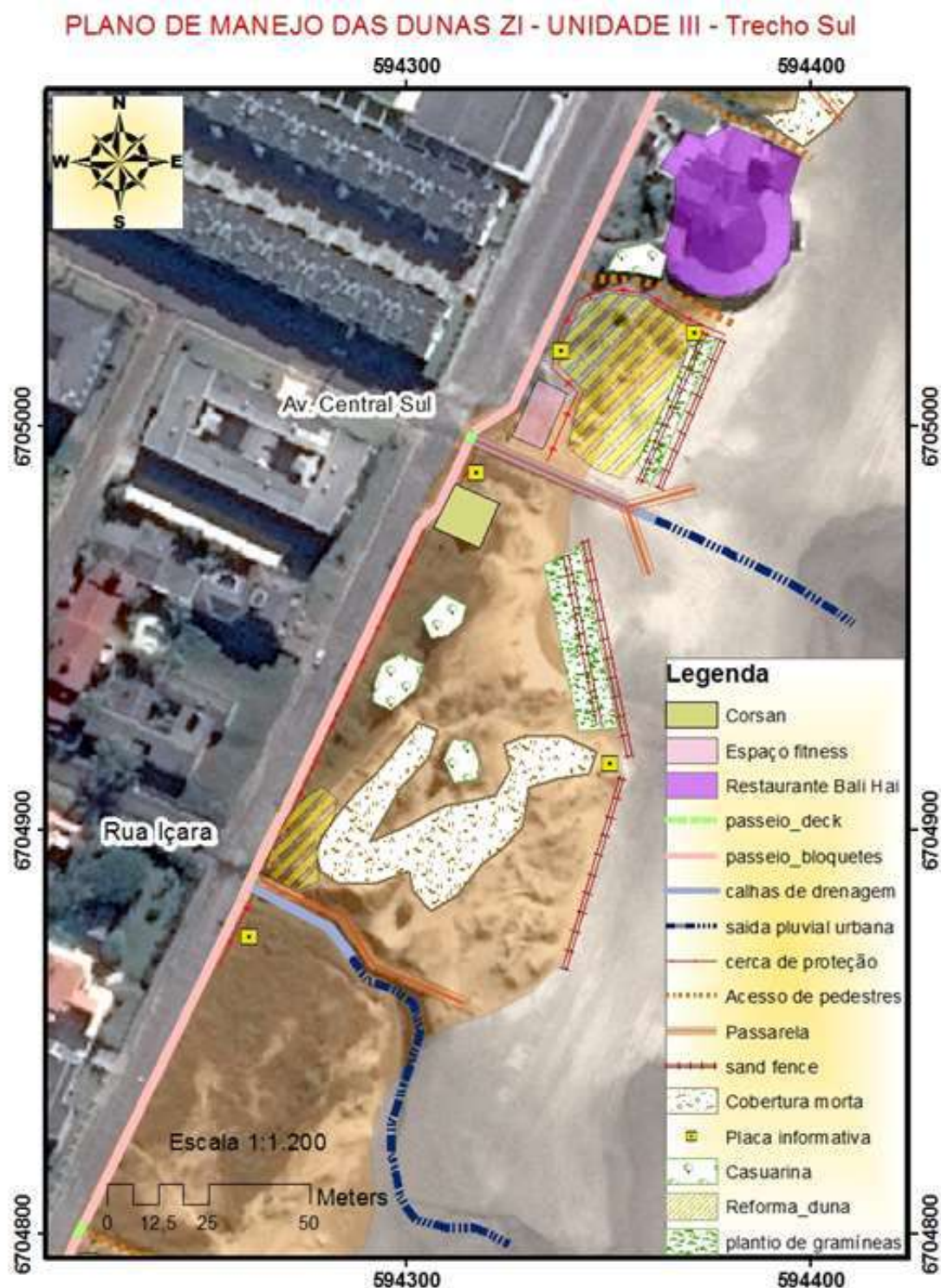
Figura 3.7- Plano de Manejo das Dunas da Zona I / Unidade 3- Setor Sul: construção e reforma de dunas no antigo estacionamento do Bali Hai, controle dos blowouts e passarela de acesso à praia pela Av. Central Sul.
